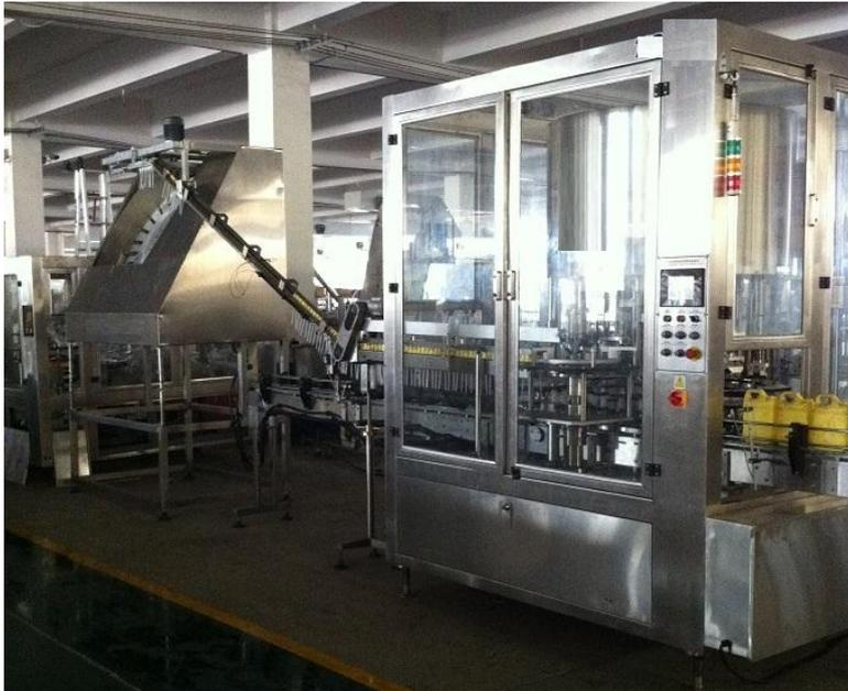
Verschiedene Flaschenabmessungen oder Verschlüsse können verarbeitet werden; der Produktwechsel mit den Wechselteilen ist einfach durchzuführen.
